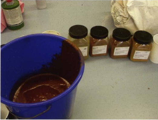
Abb. 10 Harzeinfärbung mit Pulverfarben.
