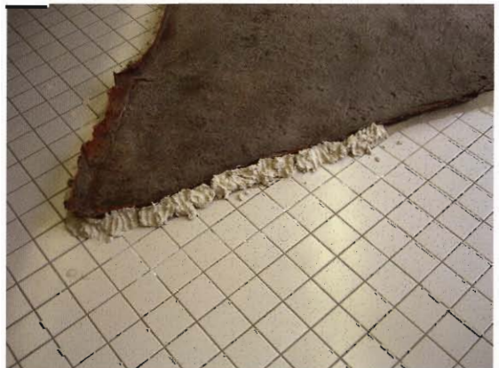
Abb. 9 Aufbau der Randarmierung mit Gips.
