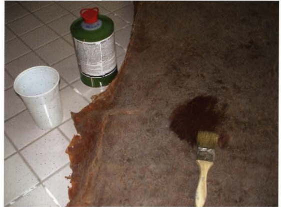
Abb. 7 Aufbringen des Formenwaxes.
