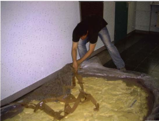
Abb. 12 Ausgeschäumte Rückseite - Felsabguss kurz vor der Wandmontage.
