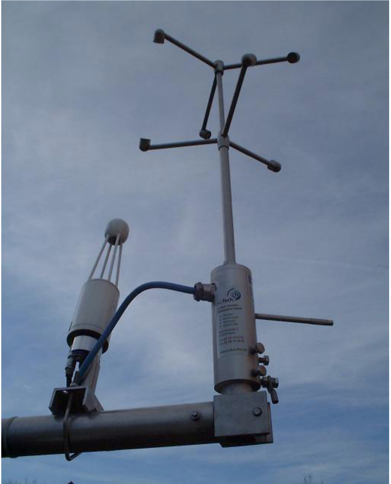
Abb. 6: Installierte Eddy-Flux-Anlage der TU Bergakademie Freiberg (links: Hygrometer, rechts: Anemometer).
